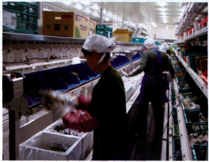
凭借临时预放台(蓝色),每天最大可处理25万点/5条线的C-DPS。左上为回收补充容器和硬纸板箱的输送机。
